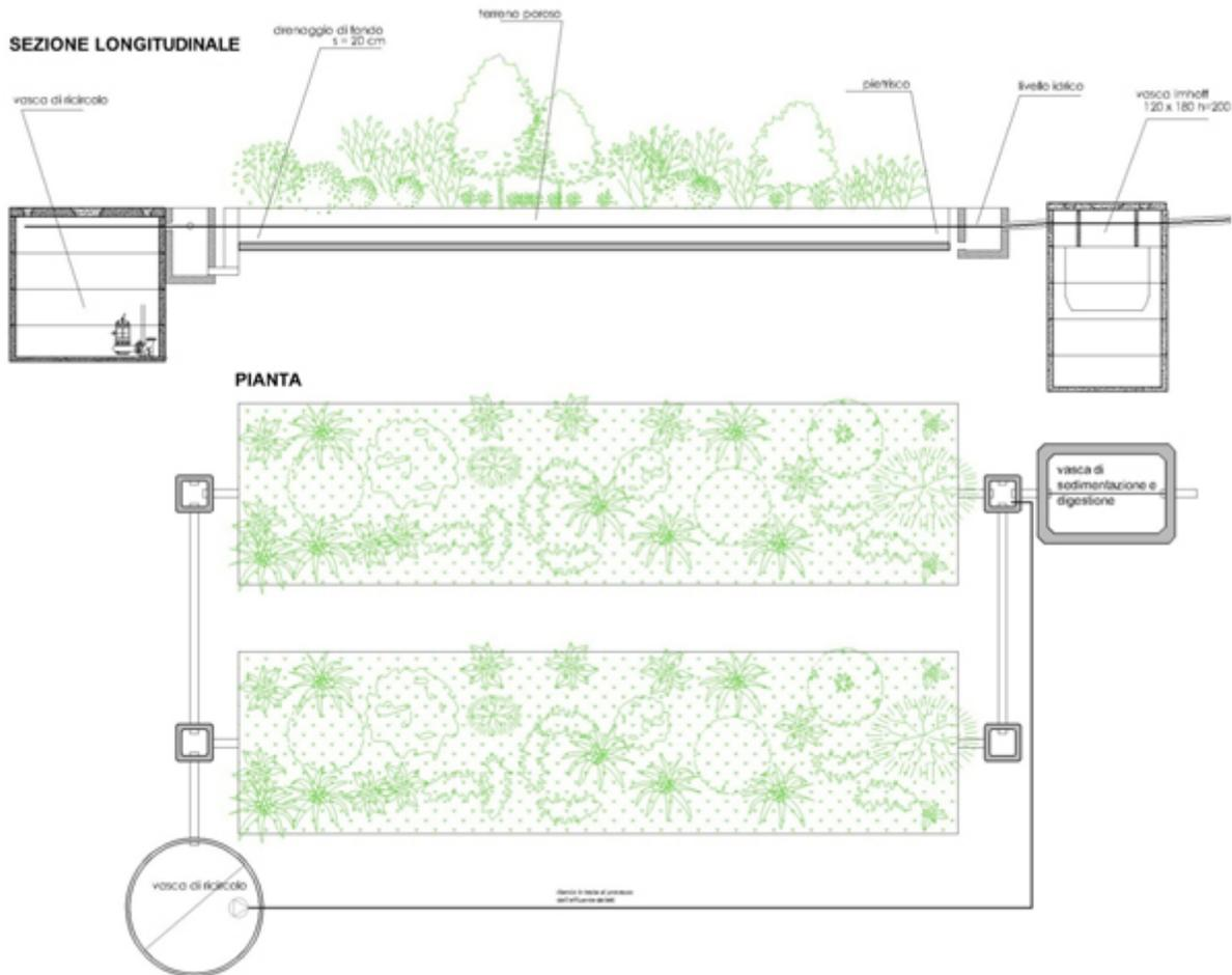
Figura 6: Impianto di fitodepurazione
